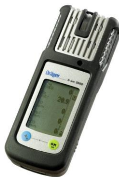
Слика бр.16. Дрегер уређај за детекцију: O 2 , CO, CH 4 , NH 3
