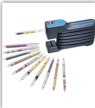
Слика бр.15. Средства за детекцију: ручна пумпа и детекционе цевчице
