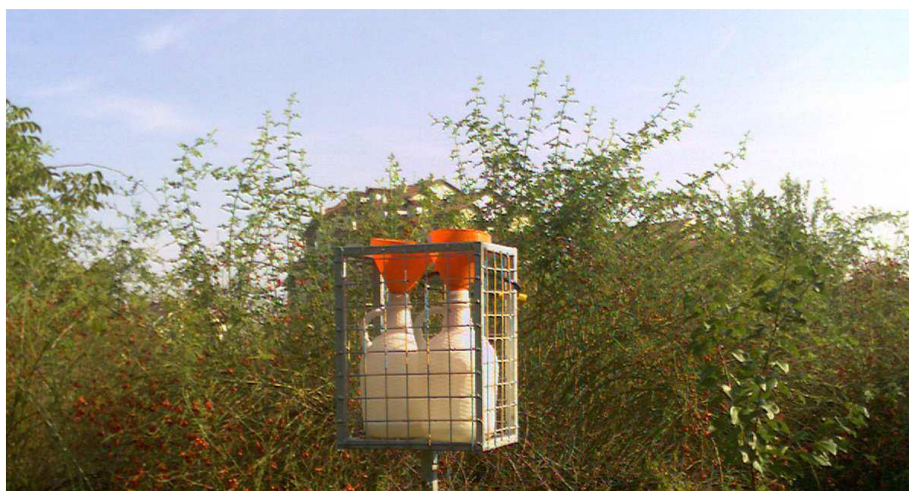
Слика 4 - Опрема за узорковање укупних таложних материја
