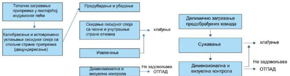
Слика бр. 16: Шема дела технолошког поступка израде кошуљица
